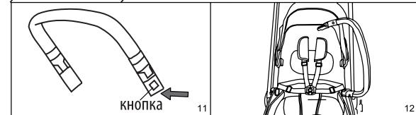
Поручень: Как показано на рис. 11 и 12, нажмите внешнюю кнопку на перегородке, а затем вытяните ее. Установка перегородки: вставьте ее в паз до щелчка.
