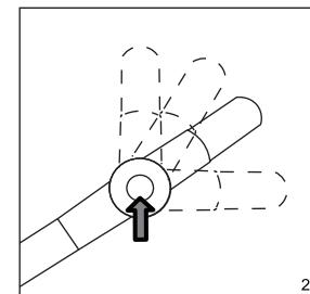
Как показано на рис. 2, имеется 4 положения для регулировки ручки. Нажмите центральную кнопку с обеих сторон и переместите ручку вверх или вниз, пока не услышите щелчок.
